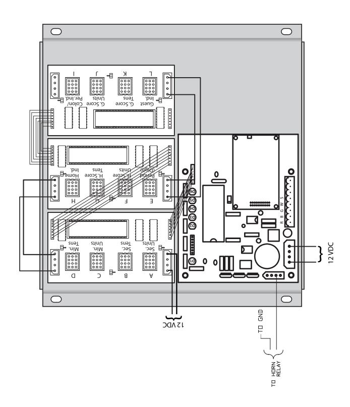
MP-5206 CONTROLLER WIRING
